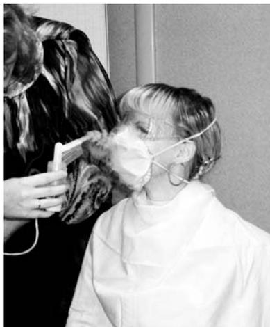
Тестирование респиратора на плотность прилегания с использованием люминесцирующего аэрозоля портативной установкой «Ингавит»
