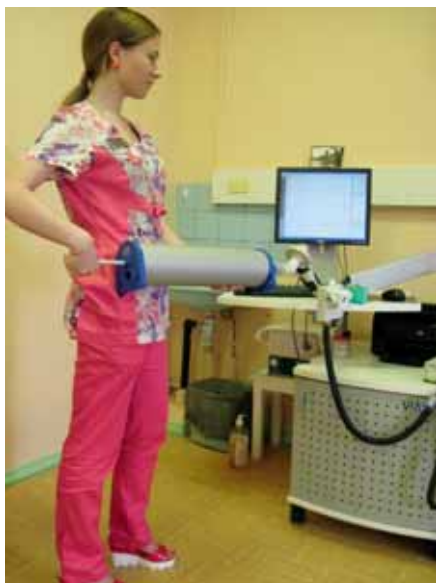
Рис. 1. Калибровка проводится ежедневно перед началом работы после внесения в прибор данных о температуре, атмосферном давлении и влажности в помещении. Эталонный объем калибровочного шприца равен 3 л.
